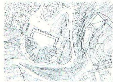
y conocimiento del monumento, haciendo siempre evidente la diferenciación entre las partes originales y las restauradas. Se ha rehabilitado la cávea con la recuperación de su perfil mediante una *concha* de piedra caliza superpuesta a la originaria, que permite siempre el diálogo entre los restos existentes y lo rehabilitado.
