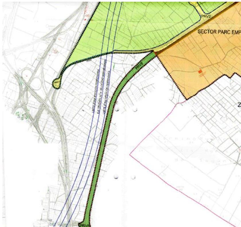
No se debe olvidar que la solución definitiva de trazado del AVE invade el trazado del PVR 8 grafiado en verde, al preverse un desvío del trazado del ferrocarril a su paso por Puçol, que dificultaba la ejecución del planeamiento urbanístico previsto. La nueva previsión recogida en la Declaración de Impacto lo inviabilizaría definitivamente si no se guarda la debida coordinación, que por medio del presente dictamen municipal se plantea.
